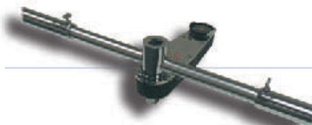
20005LDFESST型扳手,必须由2个人共同操作或者使用倍力扳手。手柄超过10英尺长。
