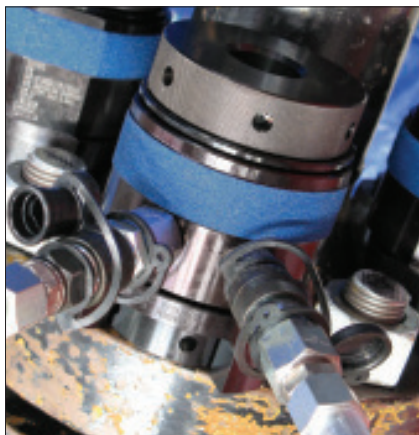
▼ 法兰接头上的GT2螺栓拉伸器。
