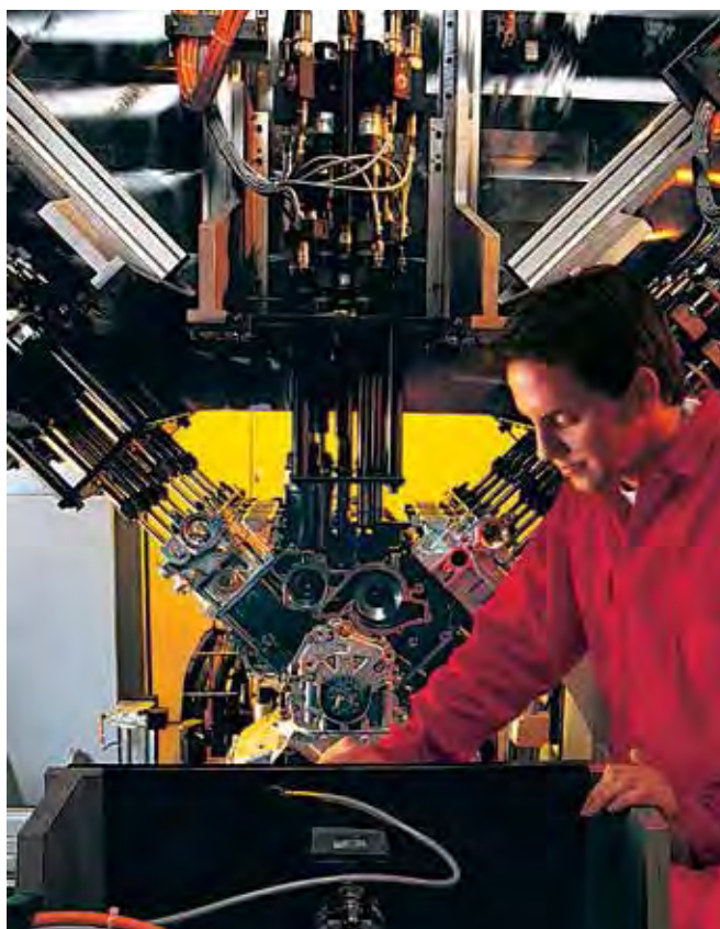
发动机装配线的自动站使用了两个相对的拧紧组，每个各有8个主轴，1个中心拧紧组有6主轴。
