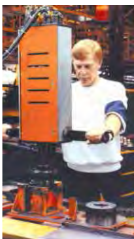
维修间的操作者正在使用两根拧紧轴来紧固轮毂装备的部件。
