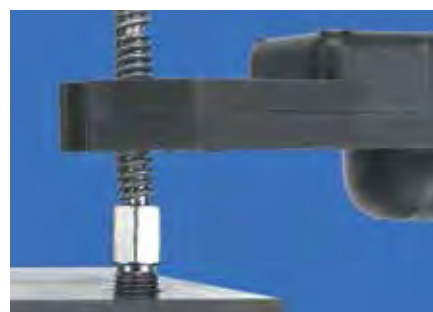
47BT工具拧紧时朝一个方向拧，当到达要求时会停止，套口会打开
